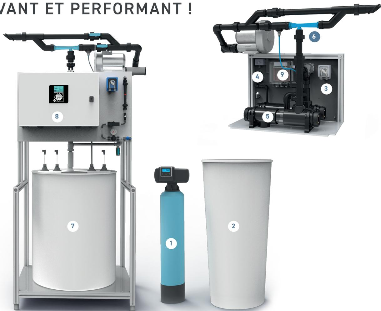
**Le système** est alimenté en permanence en eau de réseau raccordé à un adoucisseur **1** (mono ou double suivant le modèle). L'eau adoucie va alimenter le réservoir à saumure **2** ainsi que le circuit de production **4**.
